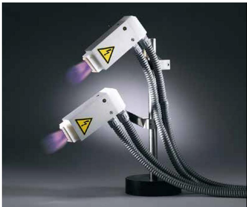
Tantec の SpotTEC は、プロファイルやケーブル、射出成形部品を処理するのに使用します。SpotTEC はあらゆる生産ラインに簡単に適用でき、極めて柔軟に使用することができます。SpotTEC は、基材表面に向かって流れる大気中における高電圧放電の原則に基づいています。
