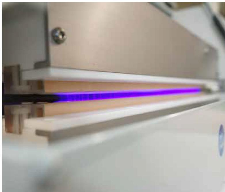
ポリマーベース材料の表面処理の目的は、放電によって表面のぬれ性を増大させることにあります。ポリマーベース基材の表面エネルギーが低いと、多くの場合インクや接着剤、塗料の接着性が弱くなります。最適な接着性を実現するには、基材の表面エネルギーを増加させて、インク、塗料等の表面エネルギーをやや上回るようにすることが不可欠です。コロナによる表面処理を行うことで、表面の接着性が向上します。
